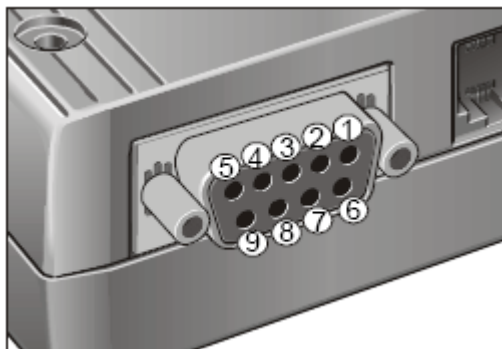
Рис. 4. Схема разъема последовательного интерфейса
