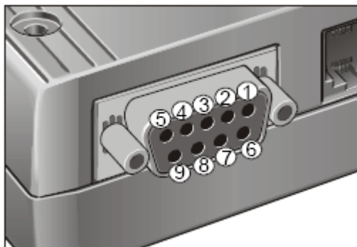
Рис. 4. Схема разъема последовательного интерфейса
